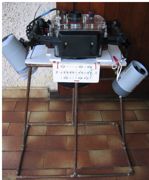
Figure 3. Appareil photo numérique à haute résolution, équipé d'un caisson sous-marin, monté sur un cadre à 4 pieds.
