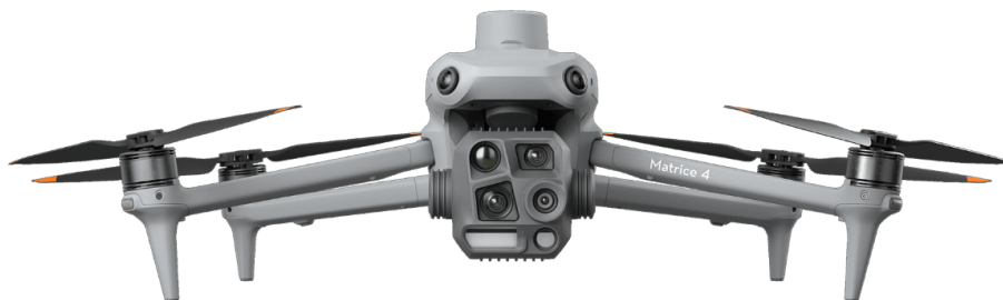
Figure 2 : Drone DJI Matrice 4 Thermique avec grand angle téléobjectif zoom 112x, thermique, vision nocturne et télémètre laser.
