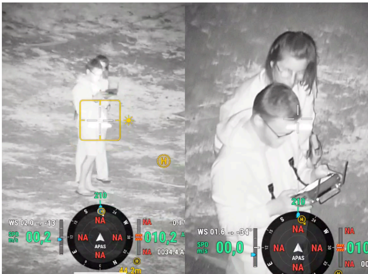
Figure 8 : Capture d'écran vidéo en vision nocturne du télépilote et d'un agent de la RNMR (à gauche à 45 m du télépilote et à droite à 18 m du télépilote). Drone Matrice 4T, 35 m ASL, drone stabilisé. On identifie les vêtements et les objets.
